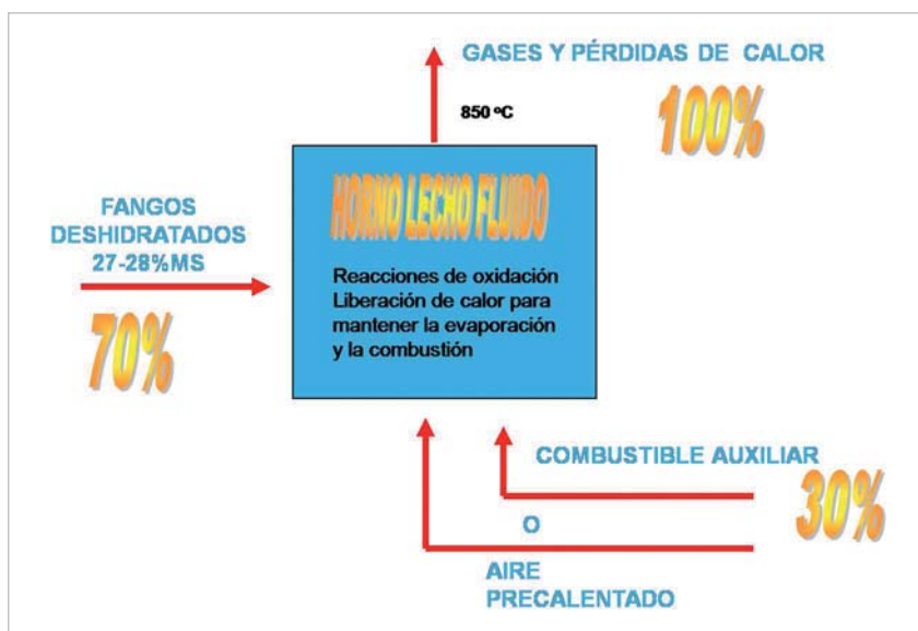
Figura 2. Balance de calor
