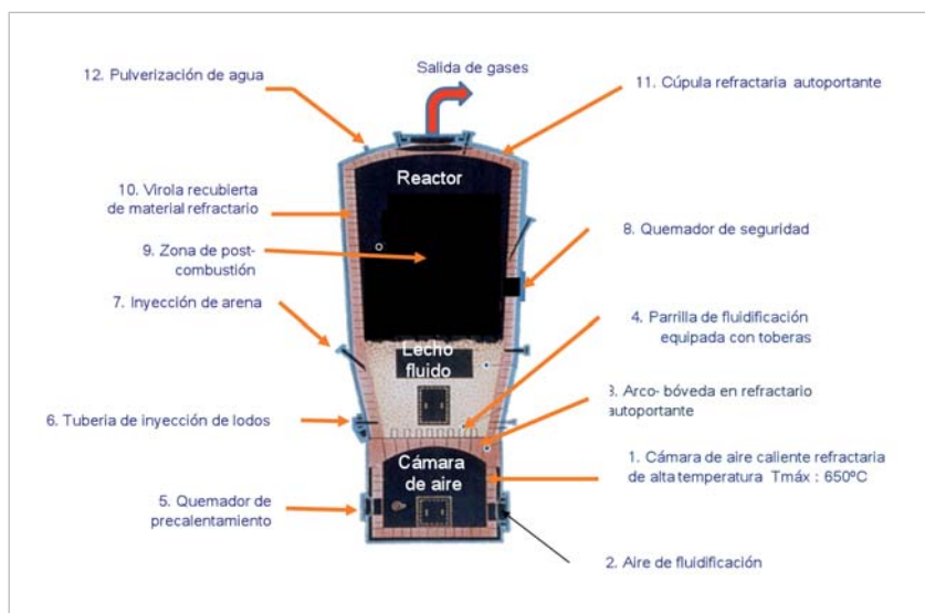
Figura nº 3b. Esquema del horno Thermylis
