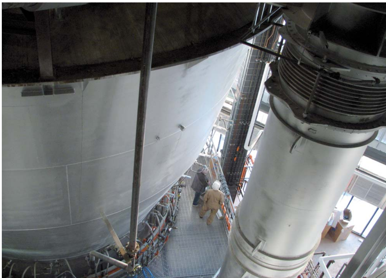
Figura 15. Uno de los cuatro hornos Thermylis de capacidad unitaria 4170 kg MS/h en Lakeview – Ontario (Canadá)
